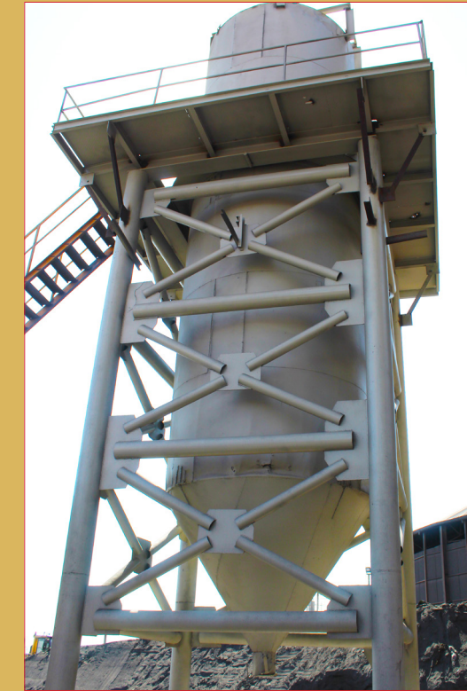
سیستم توزین و برنامه اتوماسیون مورد استفاده قرار می گیرد. با این روش کنسانتره ها طبق فرمول با تناژ دقیق با آهک و بتنویت مخلوط شده و به تولید گندله ای همگن کمک می نماید.
